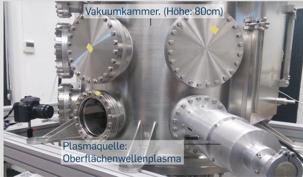
Abb. 2: Vakuumkammer. Rechts: Plasmaquelle Links: Kamera zur Aufnahme der Pendelauslenkung
