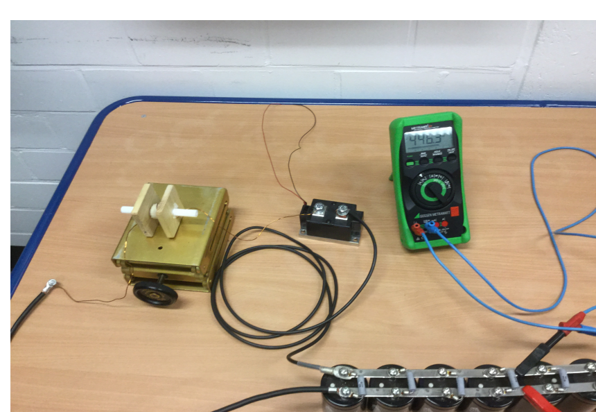
Abbildung 1: Aufbau des Schwingkreises
