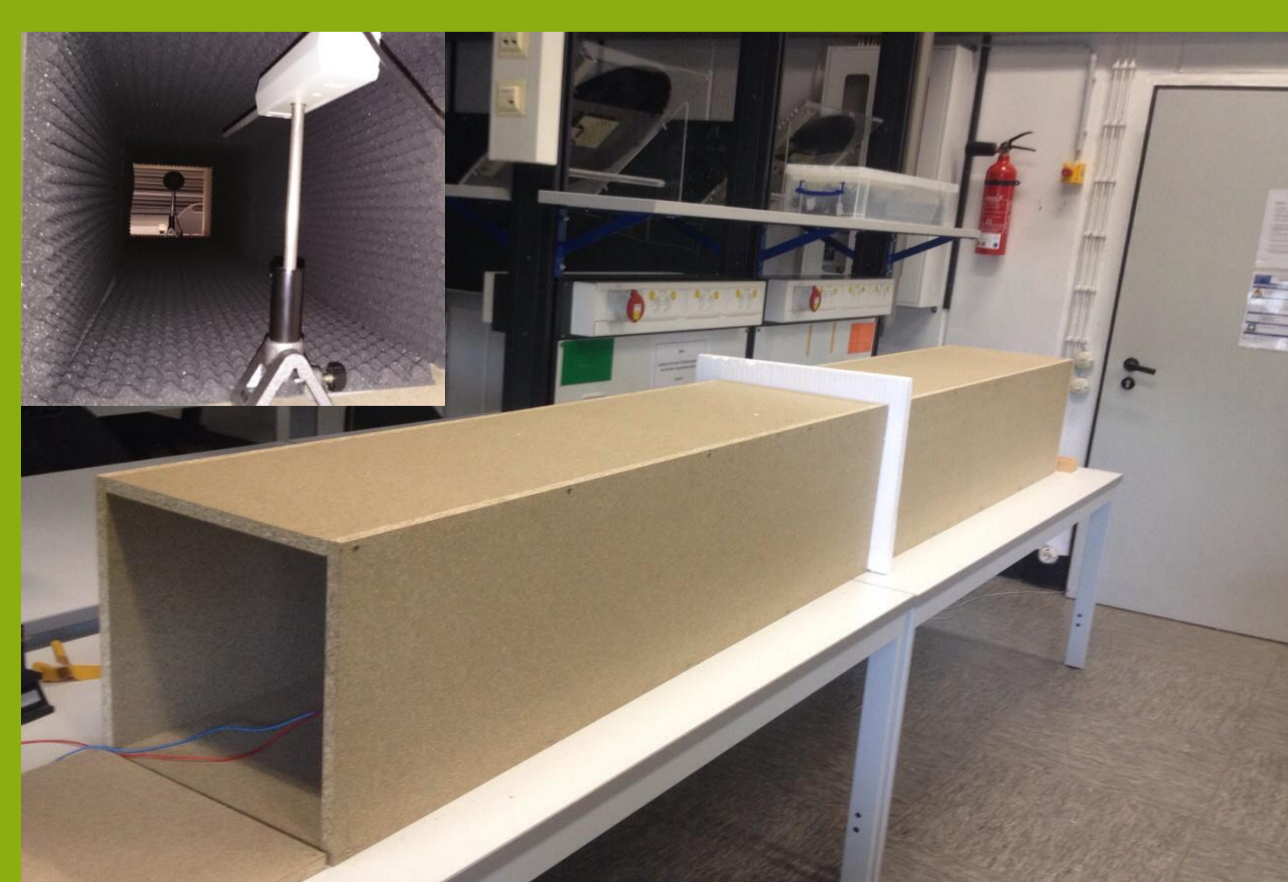
Abb. 2: Versuchsaufbau Transmission und Absorption • Transmissionskoeffizient bei kleinstmöglicher Dicke (Materialien: Spanholz, Fichtenholz, Glas, Bastterglas, Styropor, Gummi) • Absorptionskoeffizient bei unterschiedlichen Dicken (Materialien: Spanholz, Fichtenholz, Styropor)
