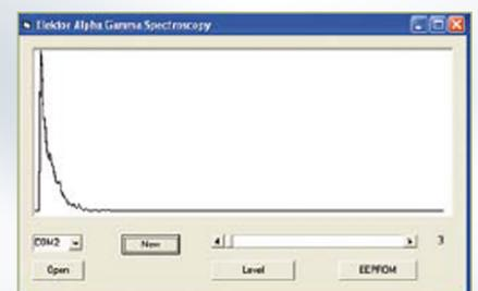
Abb. 9: Beispiel eines erwarteten Gamma-Spektrums (Pechblende hinter einer Aluminium-Folie)
