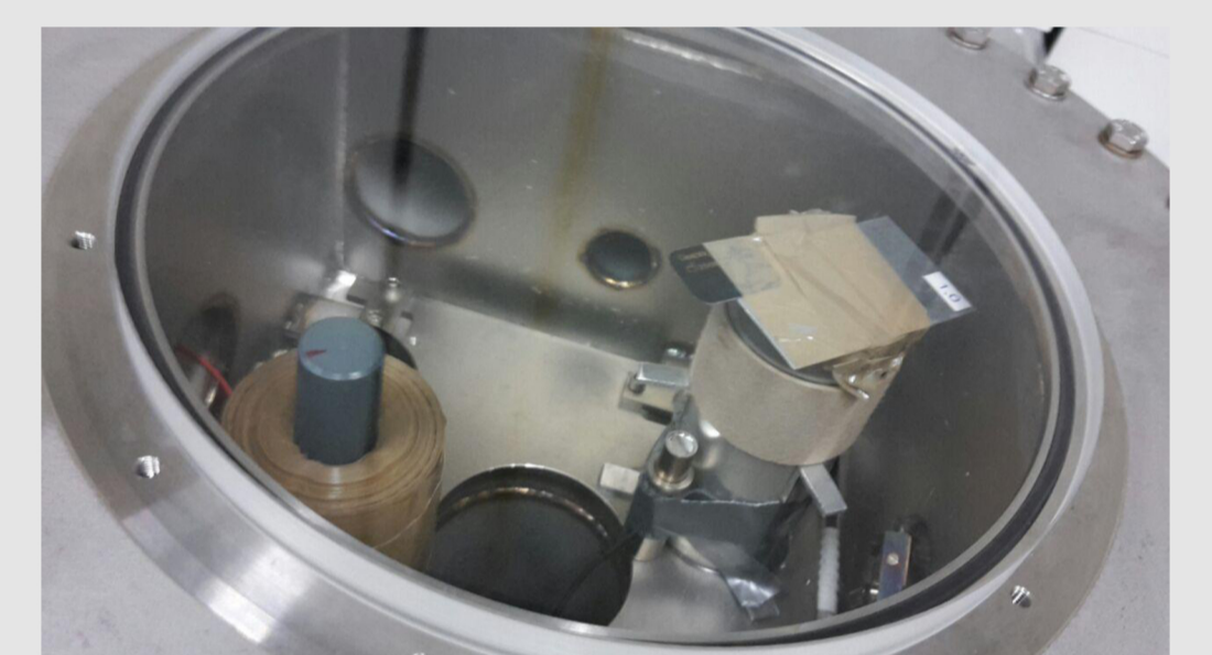
Abb. 1 - Vakuumkammer mit befestigter Röntgenplatte
