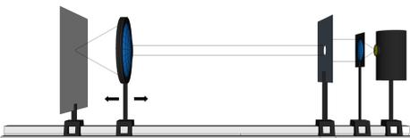
Abb.2: Brennweitenmessung an Position 1
