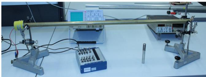
Mithilfe eines kurzen Metallzylinders werden die Stäbe am freien Ende manuell angeregt und die Spannung, welche durch die ankommende Welle und deren Reflexionen im Piezokristall erzeugt wird, vom Laptop aufgezeichnet.
