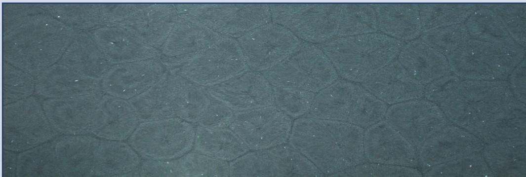
Abb. 3: Aufnahme der Konvektionszellen von Silikonöl
