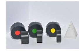
Abb. 4: Die drei Zylinder (rot:  $\sqrt{3}$ , grün:  $\sqrt{5}$ , gelb:  $2\sqrt{2}$ ) mit kleinem ( $D = 20,3\text{mm}$ ) und mittlerem ( $D = 25,0\text{mm}$ ) Durchmesser, sowie ein Pyramiden - Fehltruck
