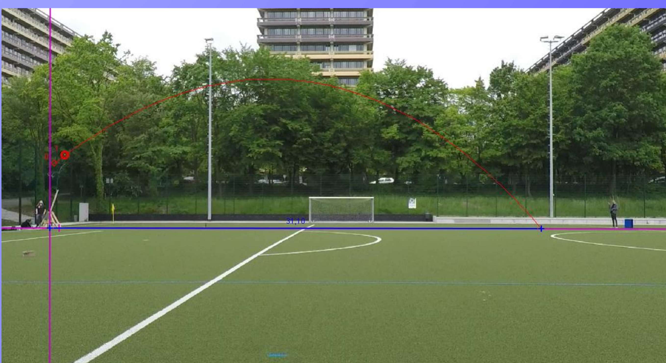
Abbildung 2: Ausschnitt der „Tracker“-Videoanalyse des Flugs der Boccia-Kugel mit 40kg Gegengewicht. Um die Wurfparameter zu ermitteln musste in mühsamer Einzelarbeit in jedem Video auf jedem Bild möglichst genau das Geschoss angeklickt werden.
