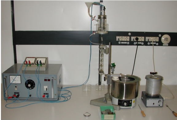
Abbildung 12.1: Der Versuchsaufbau in der Übersicht (von links nach rechts): hintere Reihe: Netzgerät und Amperemeter, Verdampfungskolben, Gefäß mit Tauchsieder, Kalorimeter vordere Reihe: Stoppuhr, Metallproben, Greifwerkzeuge
